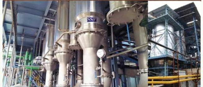
Planta de evapo-secado de POME
