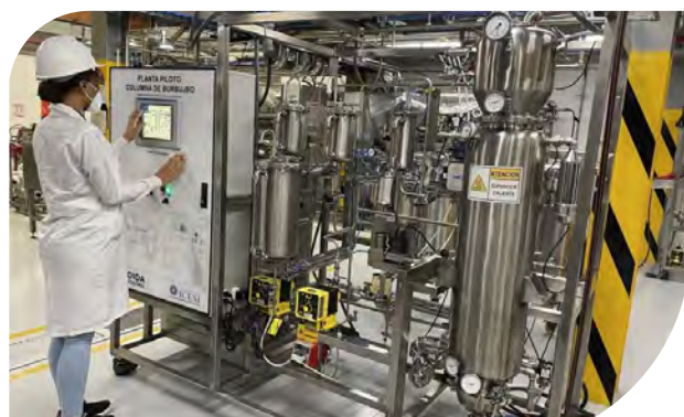
Figura 2. Columna de burbujero. Para fermentación de levaduras, bacterias y hongos filamentosos.
