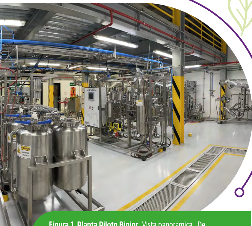
Figura 1. Planta Piloto Bioinc. Vista panorámica. De izquierda a derecha: Fermentadores tipo tanque agitado (4 unidades) y fermentador columna de burbujero. Al fondo de la columna, secador de lecho fluidizado.
