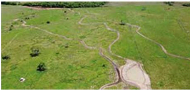
Las zanjas redistribuyen el agua por vertientes y laderas según la topografía y diseño hidrológico, disminuyendo la erosión y la velocidad de salida del agua. Ganadería Patio Bonito, Villanueva, Casanare.
